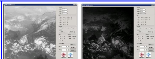
基于 MTSAT 卫星红外云图的台风客观定位系统界面 (左: 红外云图, 右: 可见光云图)
